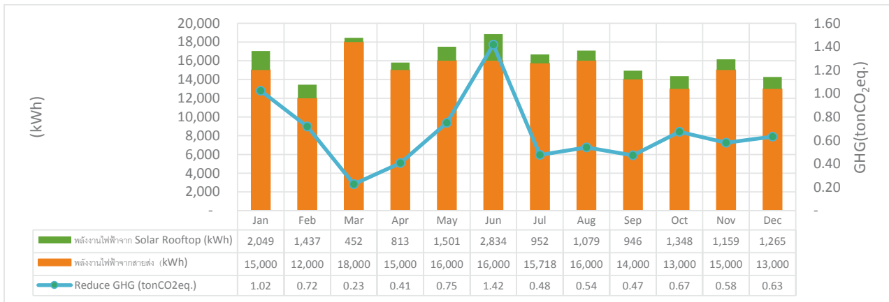
กราฟแสดงการเปรียบเทียบการใช้พลังงานไฟฟ้าจากสายส่ง-กฟน. และจาก Solar roof top ขนาด 12kW ปี 2565 – สำนักงานกรุงเทพ
