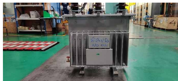
การทดสอบการใช้น้ำมันหม้อแปลงไฟฟ้าชีวภาพในหม้อแปลงไฟฟ้าขนาด 50kVA
