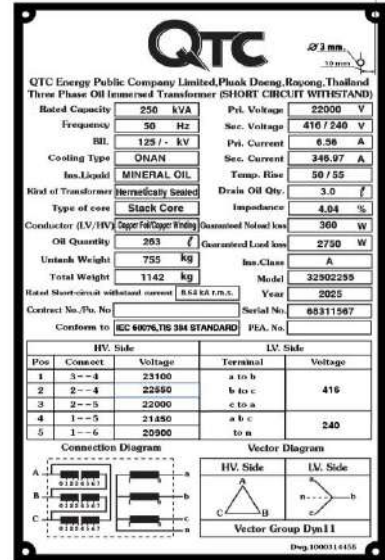
ตัวอย่าง Nameplate บอกข้อมูลสำคัญทางไฟฟ้า
